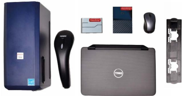
Laptop mit vorinstallierter VisionArray® Software SingleScan, Scanner 8100, Slide-Halter, Handschanner, USB-Hub, externe Festplatte, Computermaus
