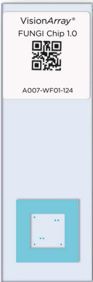
Abbildung 1: Das VisionArray®-System nutzt einen klassischen Glas-Objektträger, auf dem ein Array platziert ist.
